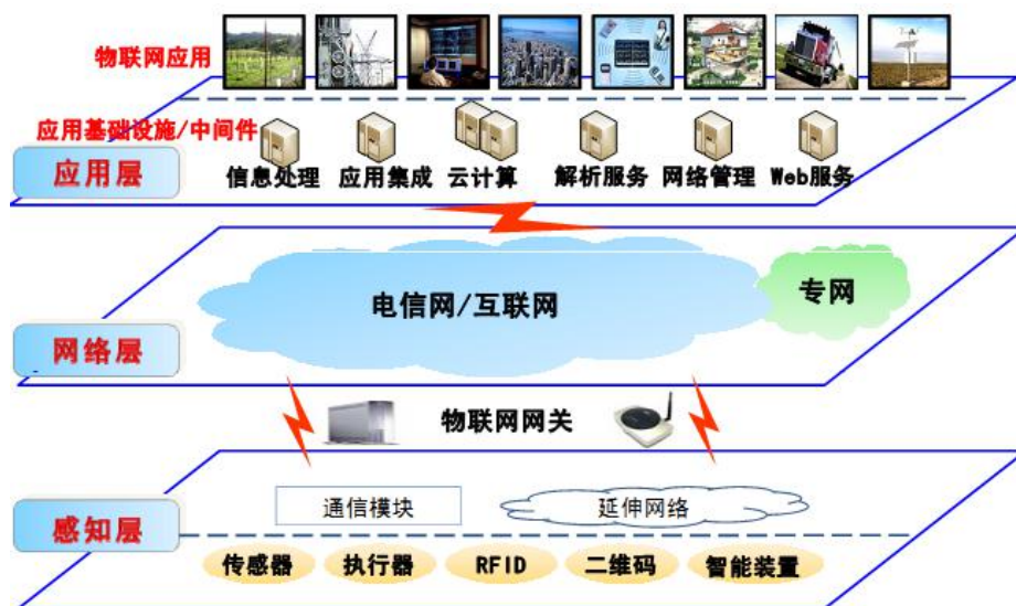
图 7-10 物联网的基本架构
